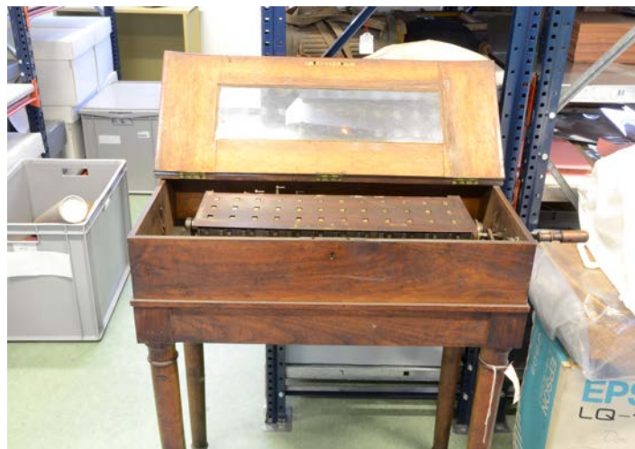
Abbildung 6: Additionsmaschine im Straßburger Museumsdepot mit geöffnetem Decker, Blick auf die 36 Schaulöcher, © Historisches Museum, Straßburg, 9. Dezember 2014
