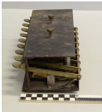
Abbildung 7: Das älteste und kleinste Versuchsmodell A des Tastenaddierers wurde wohl schon vor 1844 (Patentierung) angefertigt. Es hat keine Herkunftsbezeichnung, kann aber wegen der übereinstimmenden Bauart eindeutig Schwilgué zugeordnet werden. Das „Wellblech“ fehlt, die Ziffern sind oben auf dem Gehäuse angeordnet. © Historisches Museum, Straßburg, 9. Dezember 2014
