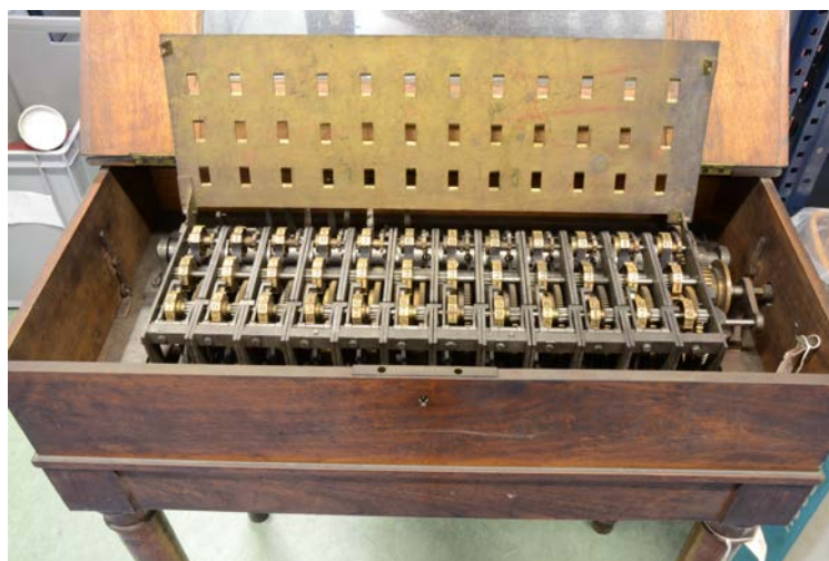
Abbildung 1: Schwilgués mechanische Additionsmaschine (um 1840) mit 36 Ziffernrädern aus Messing, © Historisches Museum, Straßburg, 9. Dezember 2014
