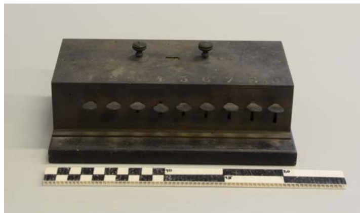
Abbildung 7: Das älteste und kleinste Versuchsmodell A des Tastenaddierers wurde wohl schon vor 1844 (Patentierung) angefertigt. Es hat keine Herkunftsbezeichnung, kann aber wegen der übereinstimmenden Bauart eindeutig Schwilgué zugeordnet werden. Das „Wellblech“ fehlt, die Ziffern sind oben auf dem Gehäuse angeordnet. © Historisches Museum, Straßburg, 9. Dezember 2014
