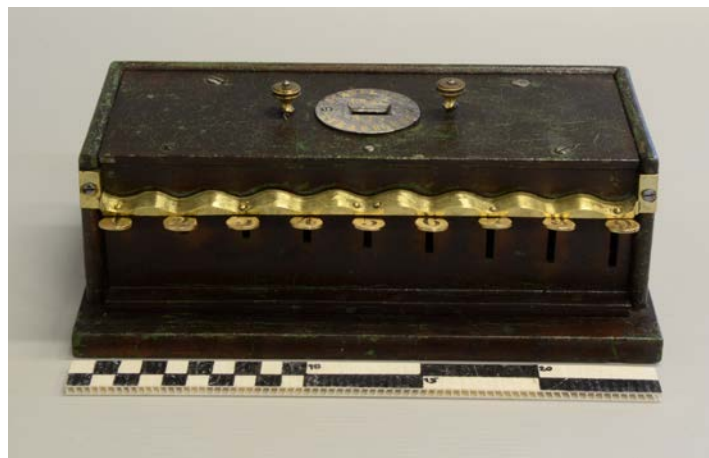
Abbildung 10: Das mit Schwilgué gekennzeichnete Modell C aus dem Jahr 1846, mit der Seriennummer 15. Es wurde äußerlich vor kurzem herausgeputzt. Wie die Modelle A und B funktioniert es leider nur noch mangelhaft. © Historisches Museum, Straßburg, 9. Dezember 2014
