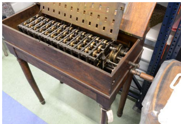
Abbildung 5: Schwilgués mechanische Additionsmaschine (um 1840) mit 36 Ziffernrädern und Kurbelantrieb, © Historisches Museum, Straßburg, 9. Dezember 2014
