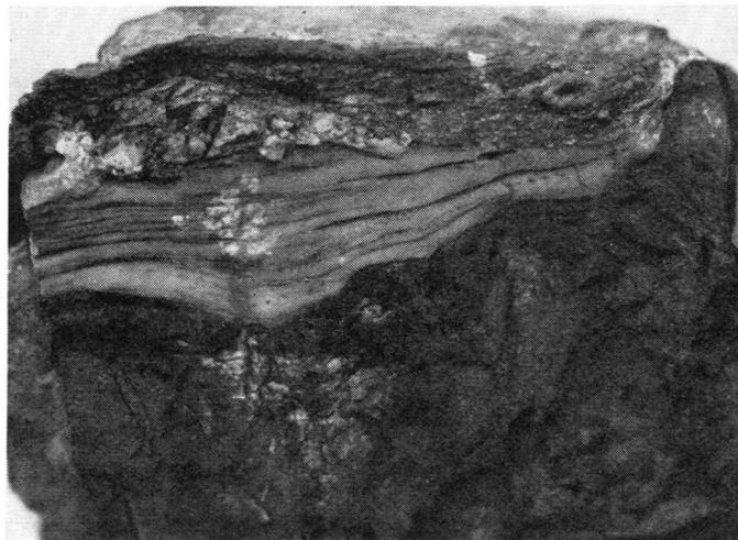
Fig. 11. Abfolge von Kristallin (oben), gebändertem Triasmarmor (Mitte, hell) und massiger Erzzone (unten).
