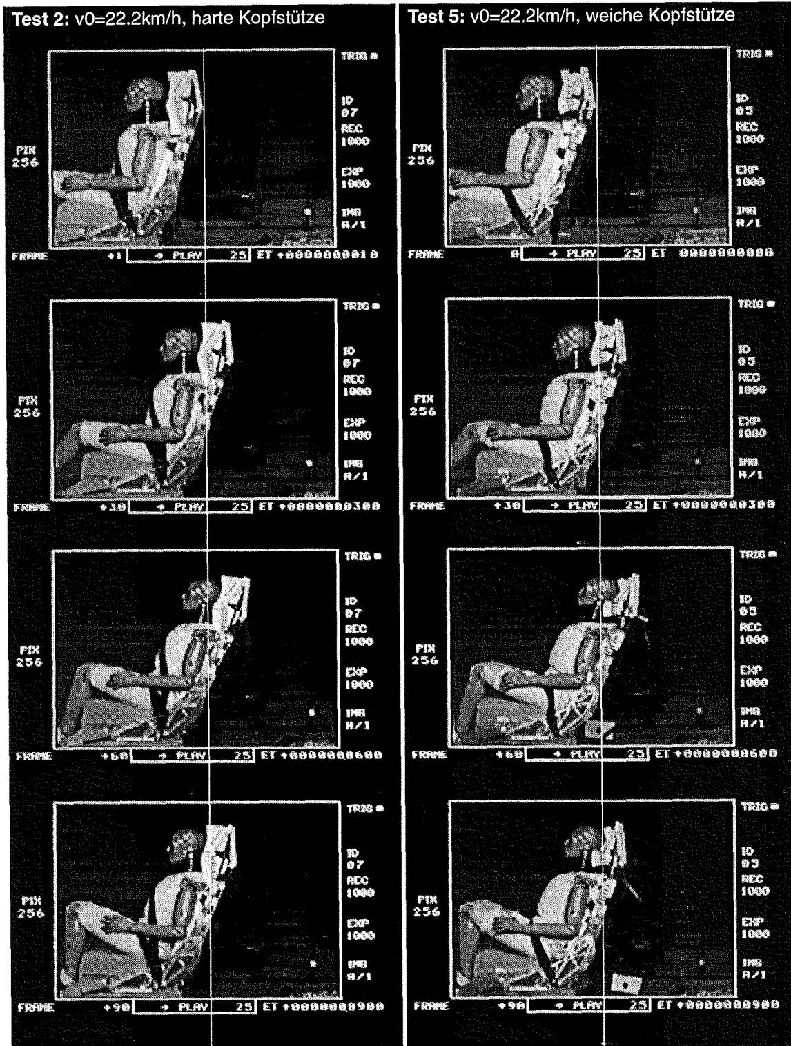
Fig.6.73: Einfluss von weicherem Polster auf Nackenkinematik, Vergleich der Versuche 5 und 2
