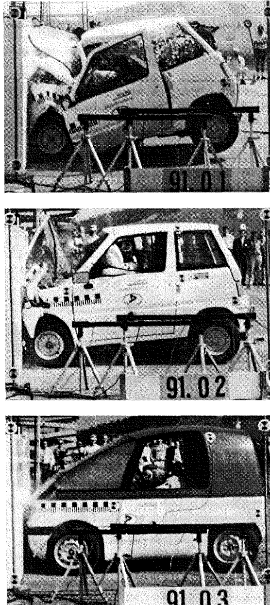
Fig.4.2: Barrierentest mit Solec Riva (oben), verstärktem Solec Riva (Mitte) und Crashy (unten), jeweils zum Zeitpunkt der grössten Dummyvorverlagerung
